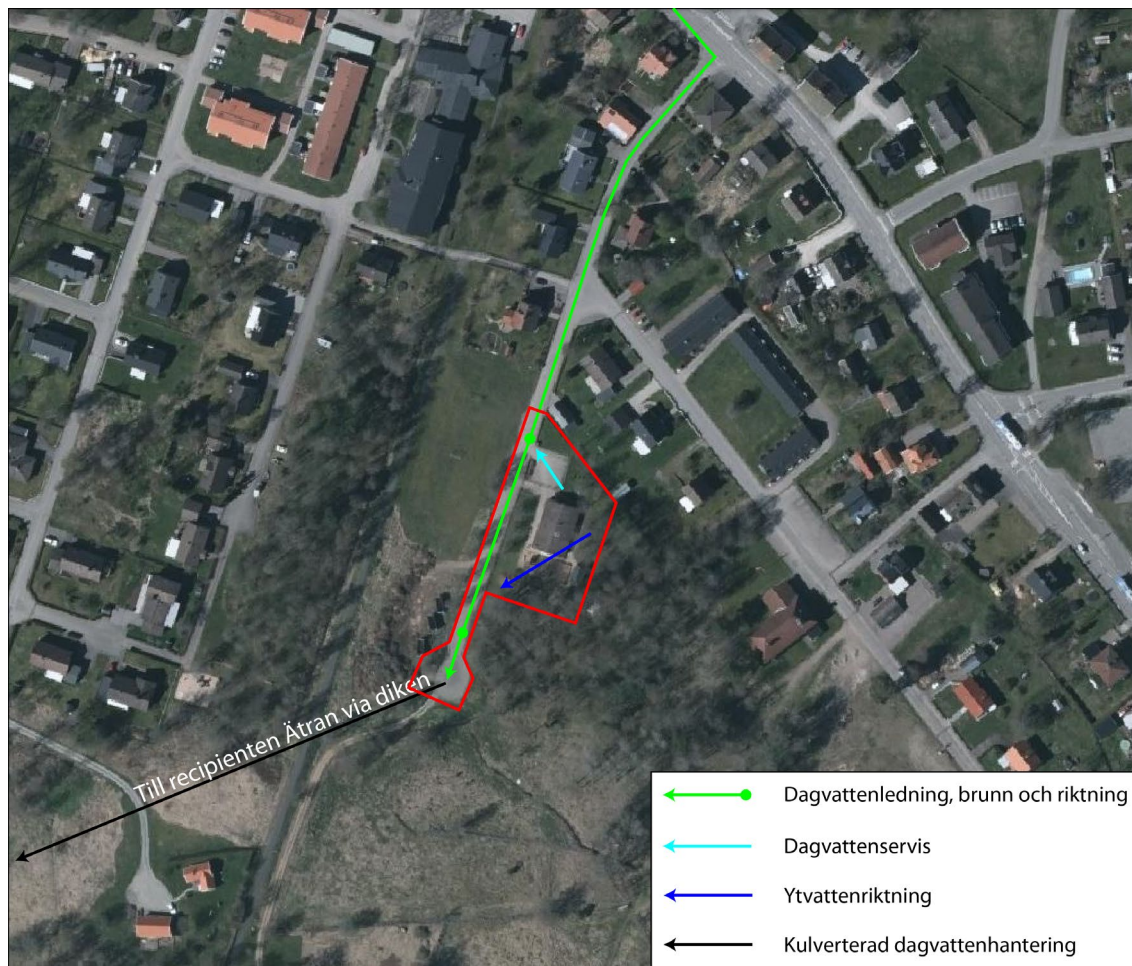
Bild 10 visar dagvattenhantering, ytvattenriktning och recipient.
